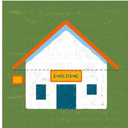
Exemple d'enseigne positionnée sous la limite de l'égout du toit
